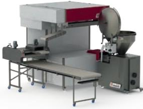
Elle permet de produire des baguettes et des pains jusqu'à une cadence de **1 500 pièces/heure**. Grâce au système exclusif MF2S® (**Mise en Forme Sans Stress**), les **baguettes sont bien régulières** tout en conservant leur structure alvéolaire. Associé à notre **système breveté RollCoup®**, il permet également de **découper automatiquement les baguettes** en petits pains (1/2, 1/3...)
