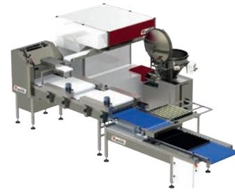
La gamme FlexiLine MERAND est principalement dédiée à la production de baguettes, bâtards et pains blancs. Plusieurs brevets ou systèmes exclusifs MERAND permettent d'apporter des solutions particulièrement adaptées pour la GMS. Par exemple, le système MF2S® (Mise en Forme Sans Stress) permet d'obtenir des baguettes bien longues sans avoir besoin de terminer l'allongement manuellement. Cela contribue à une meilleure régularité des baguettes dans les rayons.
