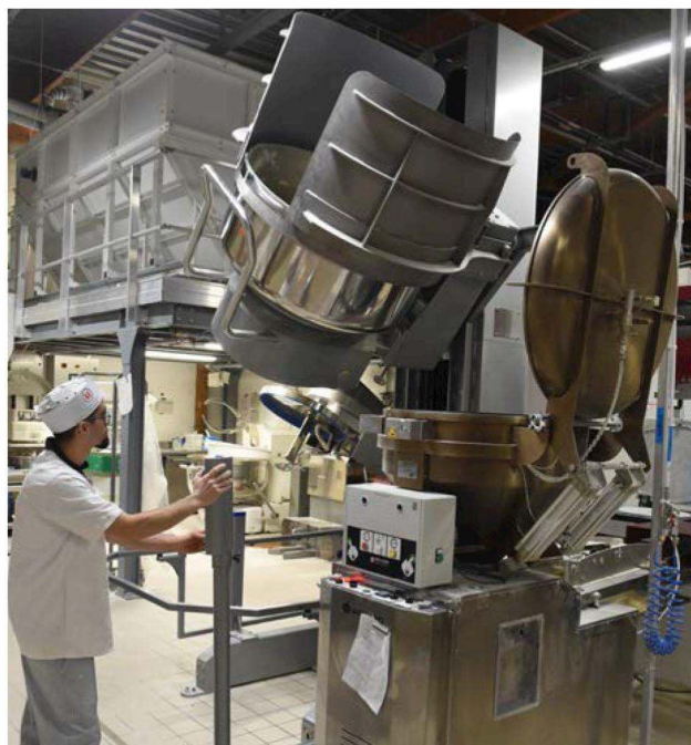
En entrée du groupe automatique Mérand, la cuve de pâte bascule de façon automatisée, sa structure alvéolaire.
