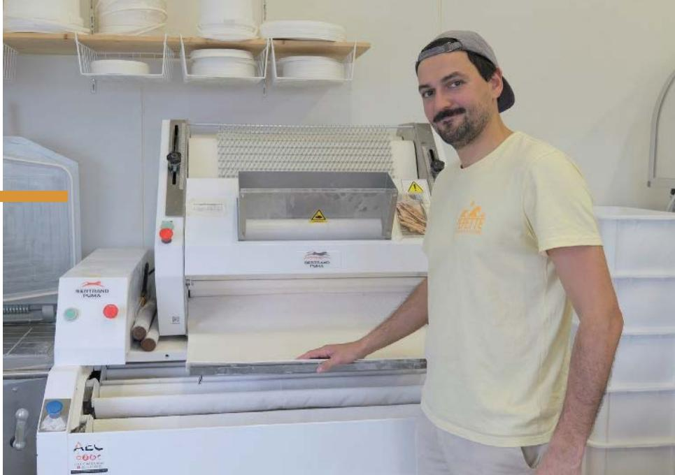
La façonneuse Euro 2000 SR est utilisée par Léo Forest-Agostini pour la production de baguettes de tradition bio au levain.
