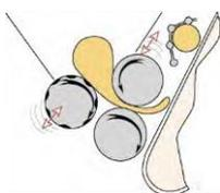
Un laminage progressif pour un meilleur façonnage (1 rouleau de pré-laminage pour conserver la structure alvéolaire de la mie et 2 rouleaux de laminage).
