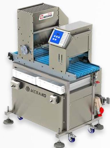
Le module de graines dépose la graine de manière homogène sur les pâtons.
