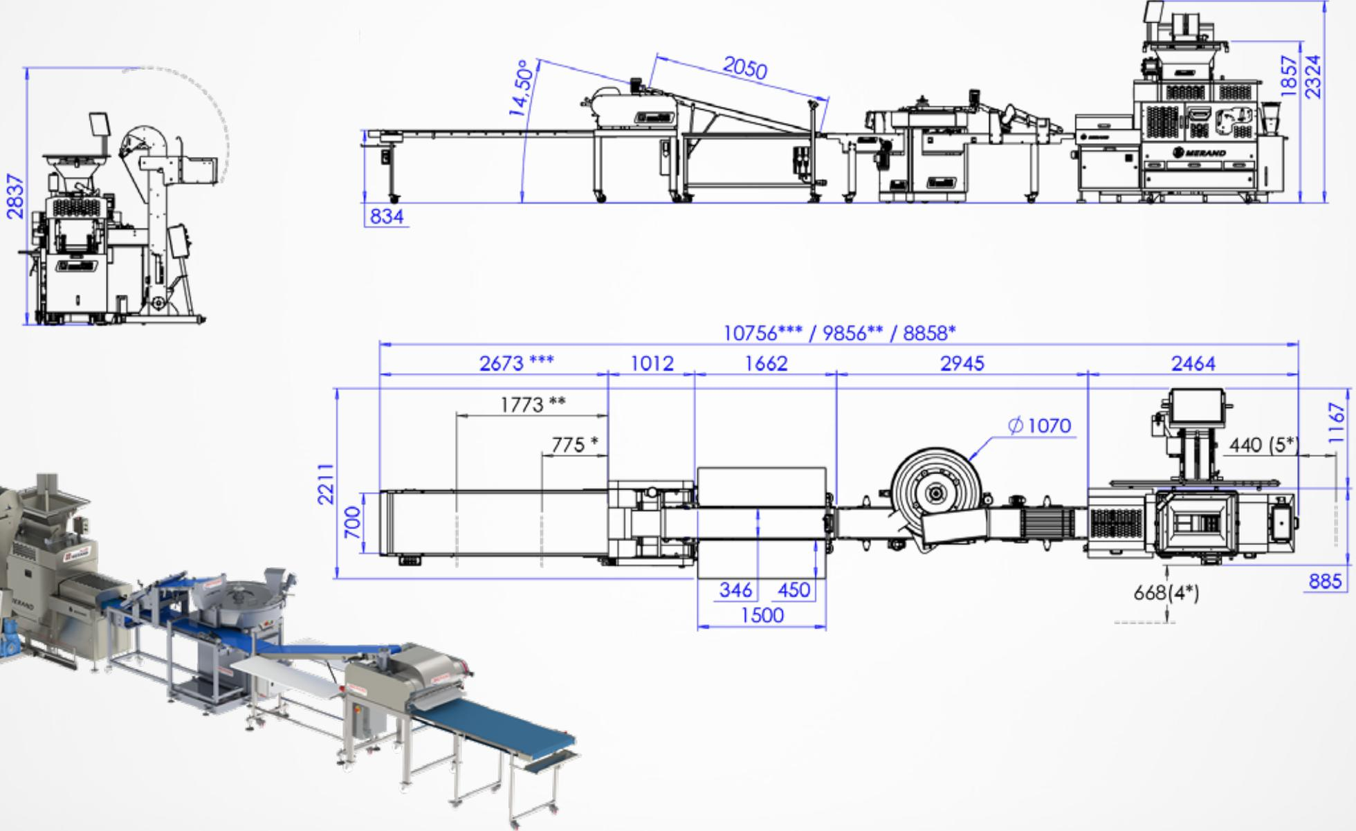
La configuración de esta línea permite tener un mayor volumen de producción, y mejorar la regularidad y la calidad de los panes finales. La línea también puede manejar el corte de rollos y la producción de baguettes blancas de alta calidad para una mayor diversidad en la producción.
