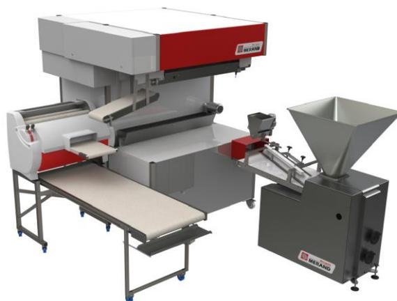
**Tren automático** : Pesadora + Cámara de reposo + Formadora + Cinta de evacuación.
