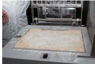
Cierra la tapa para extender la masa sin eliminar el aire (gracias al sistema VarioPress®\*\*)
