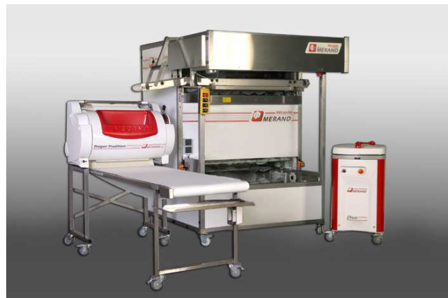
Groupe semi automatique : Diviseuse + Chambre de détente + Façonneuse + Tapis d'évacuation.
