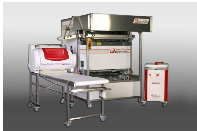
Grupo semi automático : Divisora + Cámara de reposo + Formadora + Cinta de evacuación.
